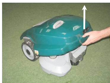
Obrázek 1.25 - Zvednutí krytu nárazníku
