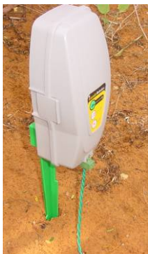
Obrázek 1.37 Spínač obvodu připevněný na kůlu
