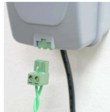
Obrázek 1.41 Konektor dílce zapojte do spínače obvodu
