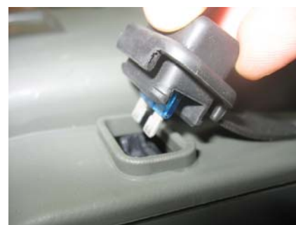
Obrázek 1.27 - Vložení pojistky baterií
