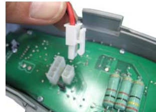
Obrázek 1.42B Zapojte zástrčku přívodu proudu do desky spínače obvodu
