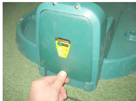
Obrázek 1.22 - Uzavření krytu stanice základny
