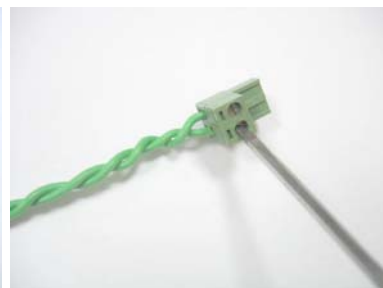
Obrázek 1.18 - Utáhněte šroubek, abyste obvodové vedení upevnili v konektoru
