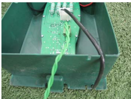
Obrázek 1.21 - Nasměrování šňůry přívodu proudu z krytu
