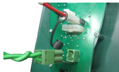
Obrázek 1.19 - Připojení obvodového vedení k stanici základny
