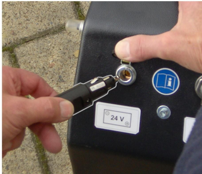
Obrázek 12: Připojení nabíječky ke stroji
