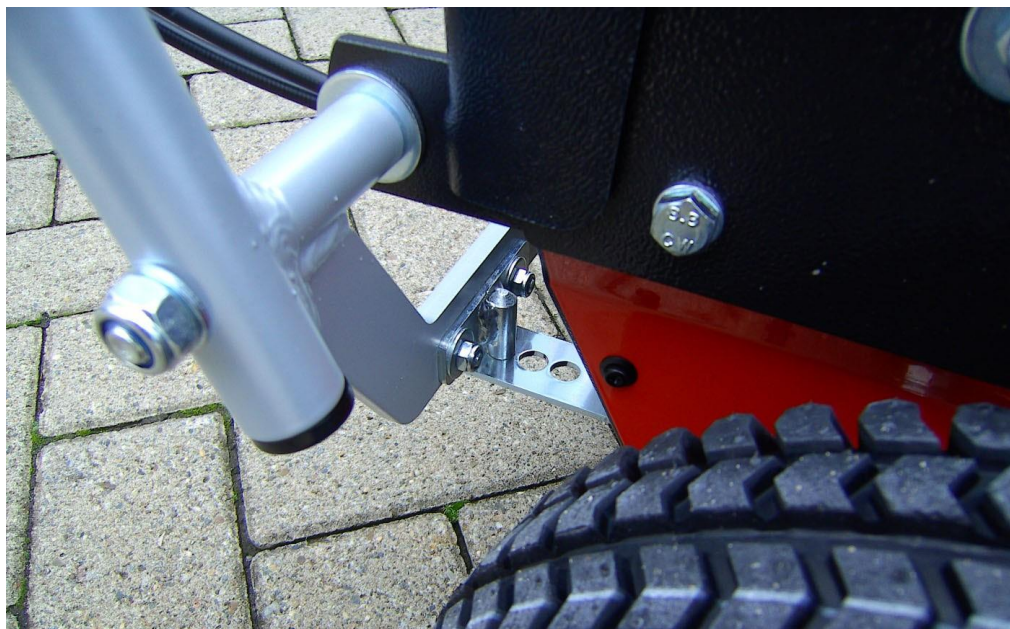
Obrázek 6: Správná montáž pojistného kolíku
