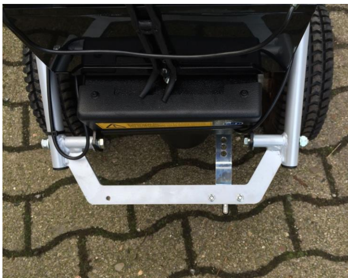
Obrázek 5: Zarovnání pojistného kolíku
