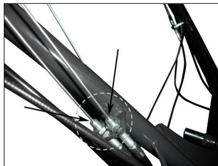
Obrázek 7-2: Mazání seřizovačů na řídítkách
